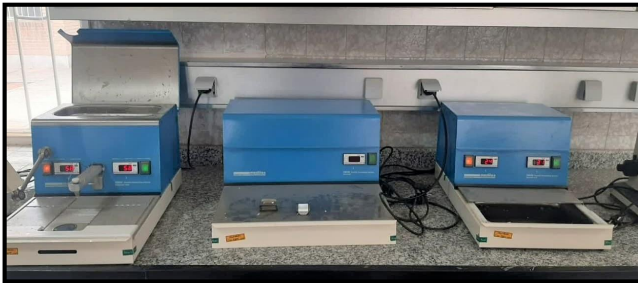
تصویر ۲- راه‌اندازی و بکارگیری دستگاه‌های Paraffin Dispenser و Thermal Unit ، Cool Unit ، Paraffin Embedding
